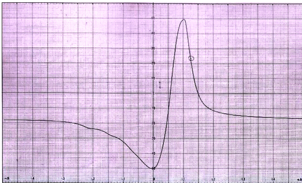
Fig. (6). ESR spectra of complex CC_{pr}AMB .
