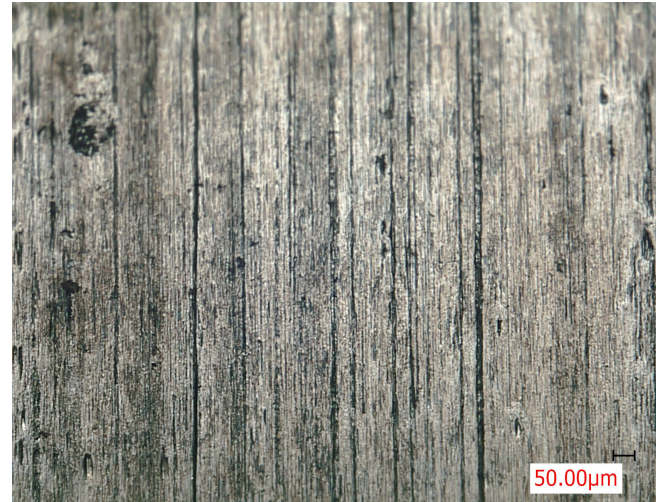
(d) 20 hours dry friction
